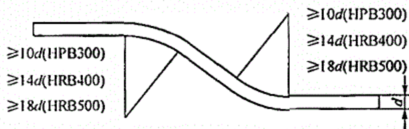
图 5.2.7—2 弯起钢筋示意图
